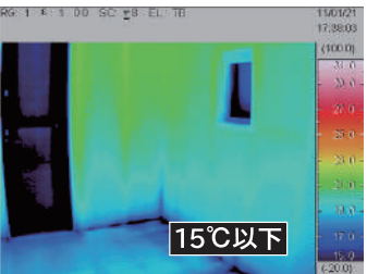
一般の断熱工法
